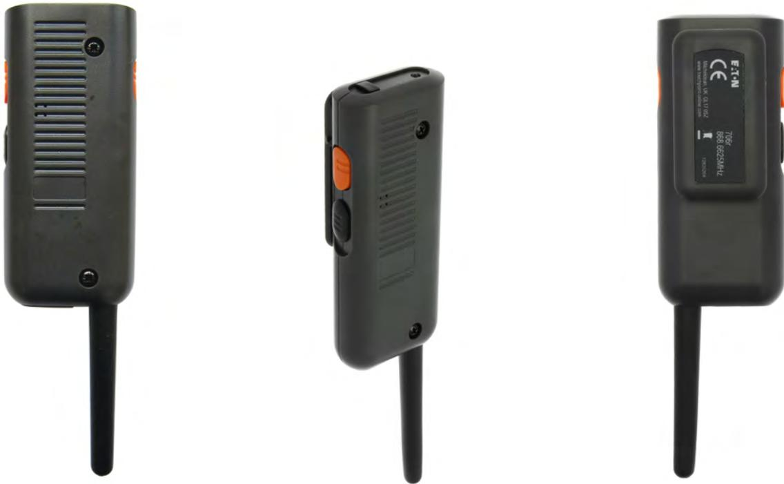
706R est un émetteur radio qui permet d'envoyer une alerte lorsque le porteur perd sa verticalité ou si celui-ci souhaite déclencher un appel d'urgence. C'est une solution simple et fiable afin de protéger les travailleurs isolés et toutes les personnes à risques.
